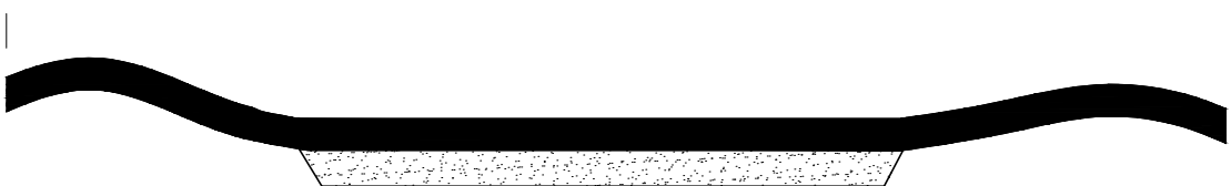
5 – CONFORMAÇÃO DE ÁREA DE EMPRÉSTIMO COM COBERTURA DE MATERIAL ORGÂNICO
